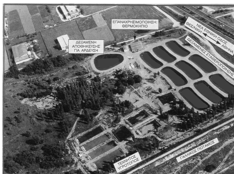
Σχήμα 8.3: Σύστημα επεξεργασίας αποβλήτων στο Γαλλικό ποταμό (ΕΘΙΑΓΕ).
