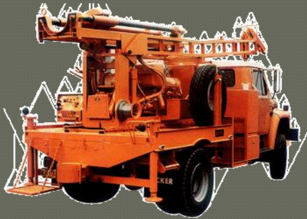
(α) γεωτρύπανο επί αυτοκινήτου
