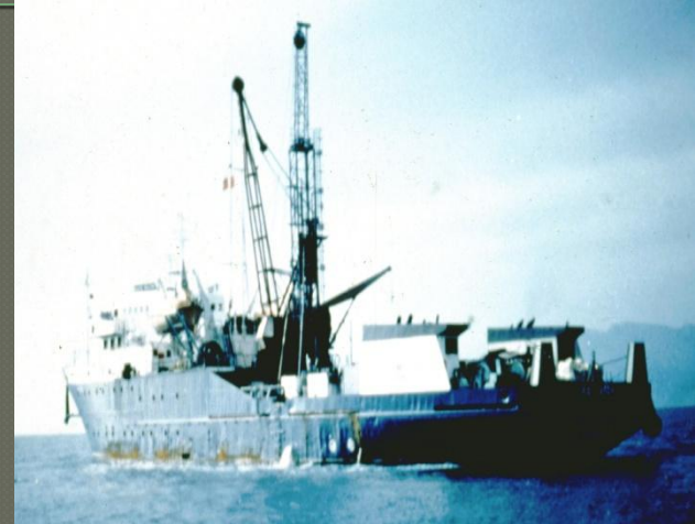
(γ) γεωτρύπανο σε πλωτό μέσο για γεωτρήσεις με βάθος θάλασσας μέχρι τα 40 m περίπου
