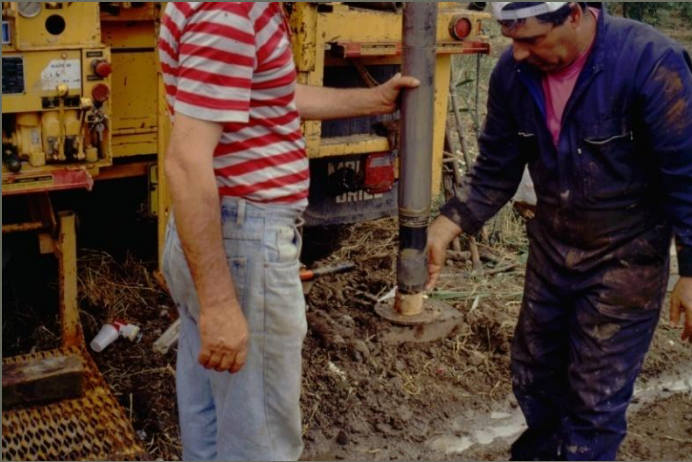
Ανέλκυση δειγματολήπτη Shelby
