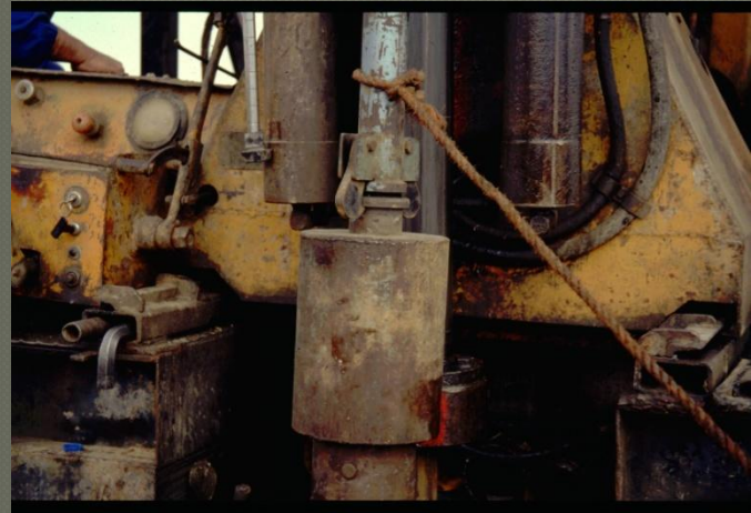
Ελεύθερη πτώση του αυτόματου βάρους των 63,5 kg
