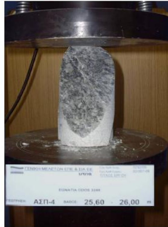
Άποψη δοκιμίου μετά τη δοκιμή Specimen after test
