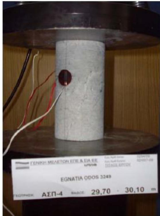
Άποψη δοκιμίου πριν τη δοκιμή Specimen before test
