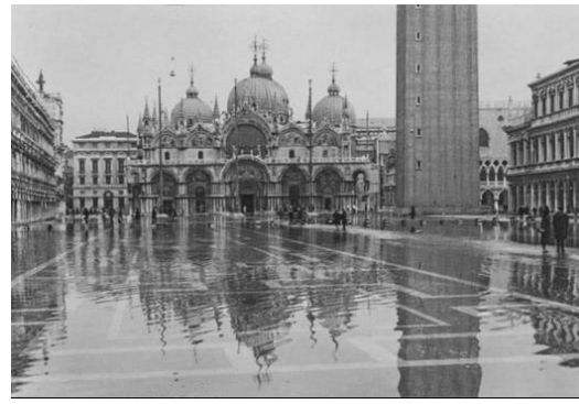
Σχήμα 6. Πλήρης κατάκλυση της πλατείας San Marco, εξαιτίας της υψηλής στάθμης της παλίρροιας (> +1.00 μέτρο)
