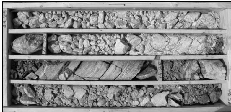
Σχήμα 11. Έντονος κατακερματισμός της βραχομάζας. Γεώτρηση ΓΣ 1 (βάθος 12-16m).
